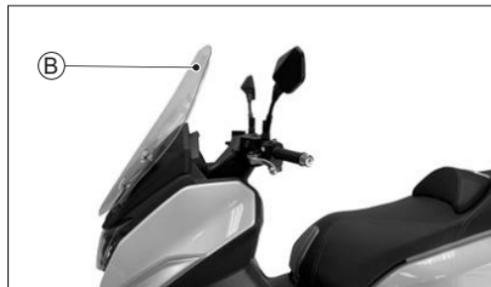
Para ajustar as posições, coloque a scooter na vertical com o suporte principal, segure o para-brisa com as duas mãos e empurre (a) para cima ou puxe (b) para baixo.
